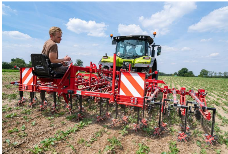
Abbildung 2: Kamerahacke mit Verschieberahmen (Machinefabriek Steketee B.V. 2021)
