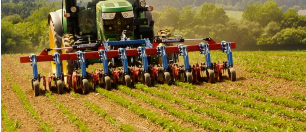
Abbildung 6: Geschobene Fronthacke mit Stützrädern zwischen Rahmen und Traktorvorderreifen (Thomas Hatzenbichler Agro-Technik GmbH)
