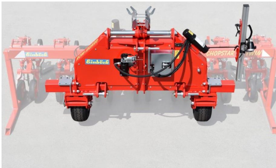
Abbildung 3: Aufbau eines klassischen Verschieberahmens. Dieser entkoppelt den Hackrahmen vom Fahrzeug, damit sich dieser unabhängig vom Fahrzeugheck bewegen kann (Einböck GmbH 2020)
