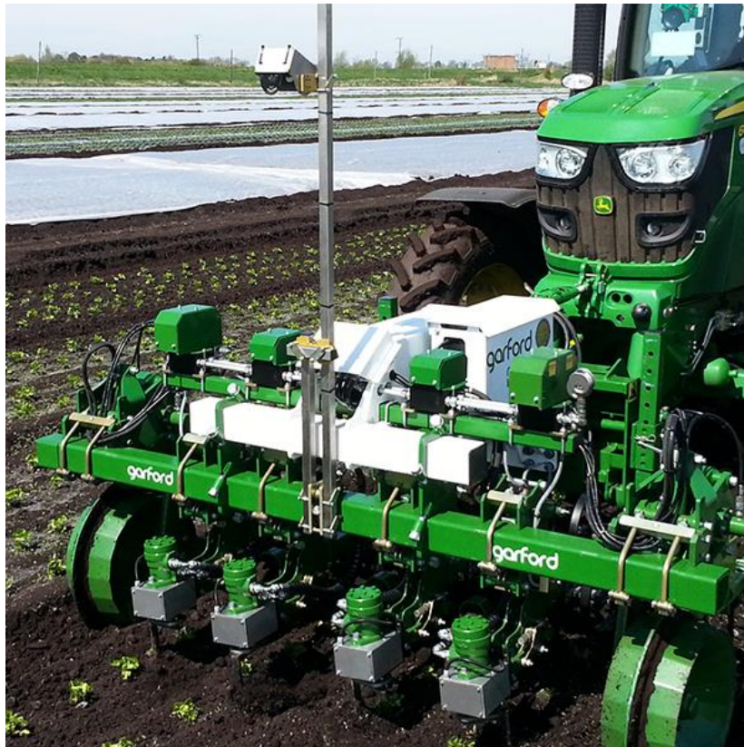
Abbildung 16: Robocrop InRow Weeder im Frontanbau mit gelenkten Sechrädern (Garford Farm Machinery Ltd 2021)
