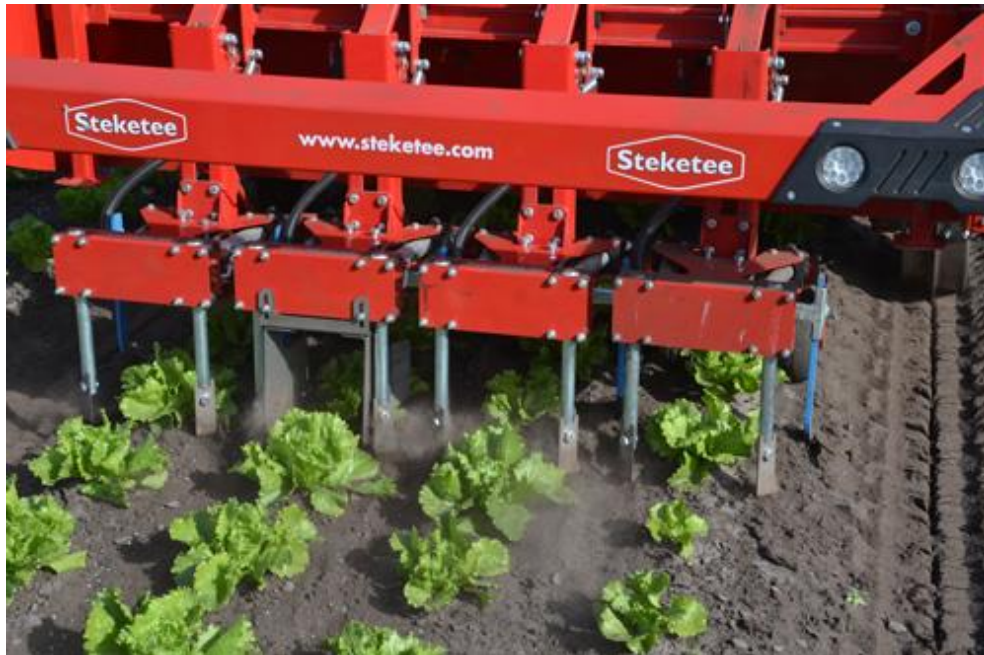
Abbildung 18: Die pneumatischen Werkzeuge des IC-Weeders schwenken über eine 90°-Bewegung in die Reihe (Maschinenfabrik Steketee B.V. 2021)
