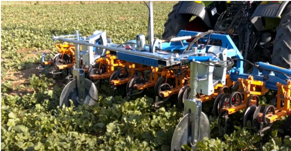
Abbildung 5: Anbaugerätelenkung über Lenksechsscheiben (Raven Industries, Inc. 2021)
