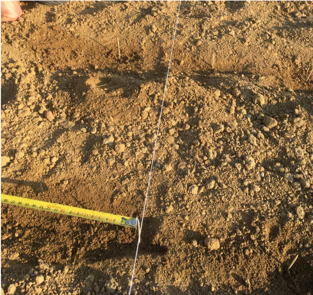
Abbildung 35: Ermittlung der Standraumverteilung in Fahrtrichtung: Zahnstocher markieren die Pillenpositionen, weißer Bindfaden markiert die Sollposition
