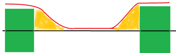
Abbildung 21: Skizzierte Einschwenkkurve des in Abbildung 20 gezeigten Werkzeuges: Pflanzenbereich grün, Bahnkurve Aktor rot, unbearbeitete Fläche orange.
