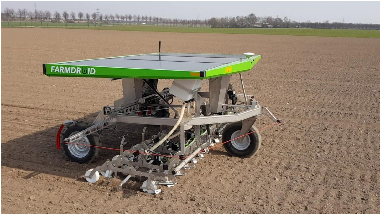
Abbildung 14: Sä- und Jätroboter FD 20 der Firma Farmdroid (FARMDROID ApS 2020)
