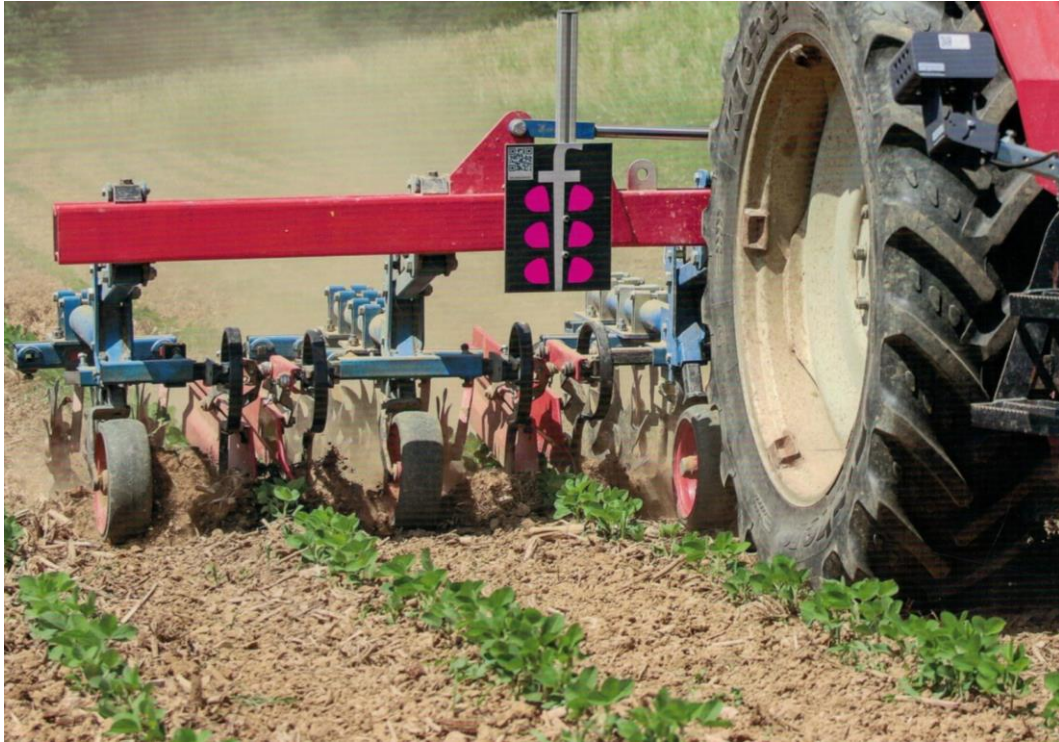
Abbildung 8: Direkter Positionsabgleich zwischen Kamera und Kulturpflanzenreihe (Nalatec GmbH 2019)
