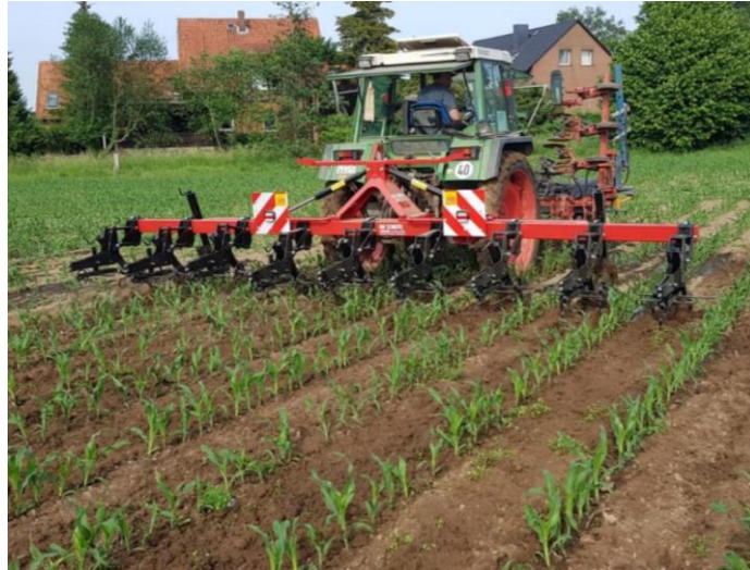
Abbildung 1: Heckhacke ohne Verschieberahmen (Maschinenring Hannover 2020)
