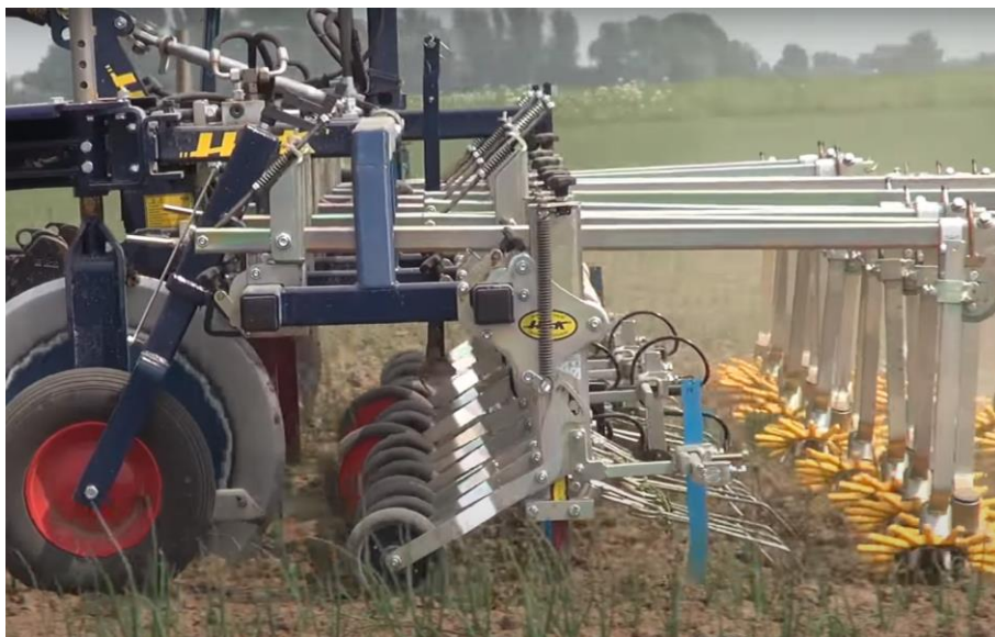
Abbildung 62: Linearführung der Firma HAK (K.A. Havelaar & Zn bv 2021)
