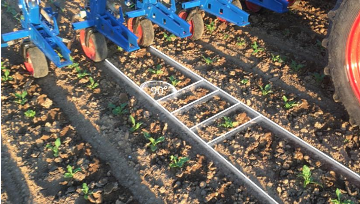
Abbildung 39: Senkrechter Schnitt durch die Pflanzenreihe verursacht durch schräg gestellten Rotor
