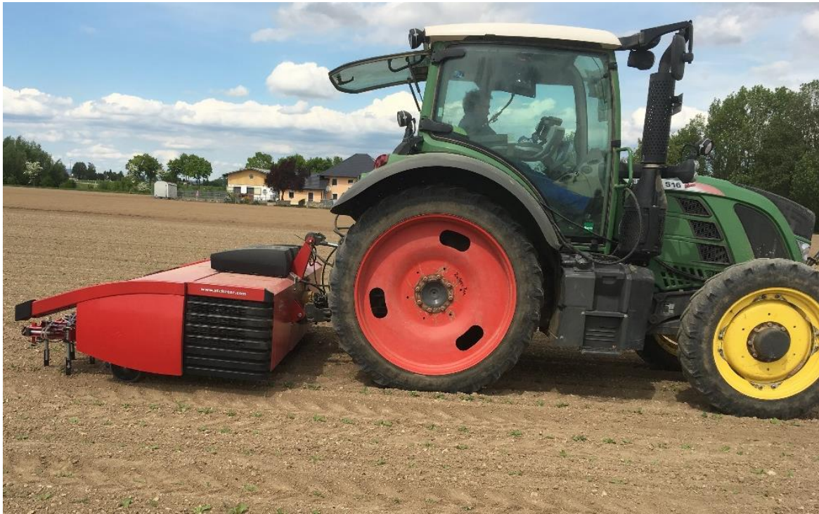
Abbildung 17: IC-Weeder im Heckanbau: Verschieberahmen und Kameras befinden sich unter der Abdeckung (Heinrich 2018)
