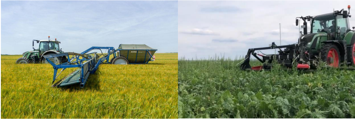
Abbildung 13: Abschneiden der Samenstände mithilfe von Messerbalken Links: Messerbalken mit Bunker zur Aufnahme der abgeschnittenen Samenstände (Zürn Harvesting GmbH & Co. KG 2021). Rechts: Doppelmesserbalken (BB Umwelttechnik 2019)
