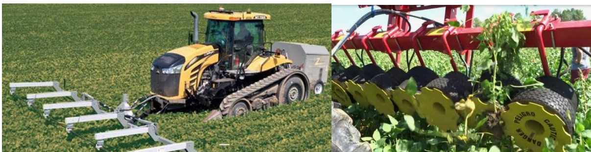
Abbildung 12: Thermoelektrisches System links und ziehendes System rechts (Kttn News 2020; Simard et al. 2019)
