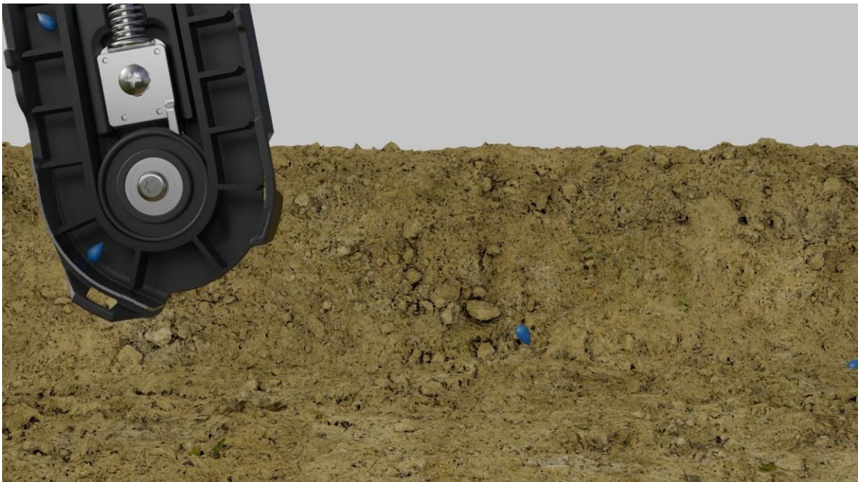
Abbildung 60: Nullablagensystem mit pneumatischer Vereinzelung und Speedtube (Precision Planting 2021)
